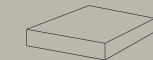
SCALINO ANGOLARE INCOLLATO GLUED CORNER STEP TREAD / CARREAU DE MARCHE COLLÉ PIÈCE ANGULAIRE / GEKLEBTE STUFENPLATTE ECKSTÜCK / PELDAÑO ESQUINA CON PERFIL PEGADO ▲ 33x33 (13"x13") RT 9mm
